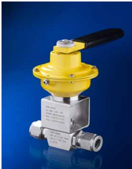
Die VSM-Federschlusseinheit mit Totmannfunktion ist eine robuste und zuverlässige Möglichkeit zur manuellen Probeentnahme. Die Armatur wird mittels einer 90° Drehbewegung über einen Edelstahlhandhebel geöffnet. Sobald der Handhebel freigegeben wird, schliesst sich die Armatur über eine Feder automatisch (Totmannfunktion). Lieferbar für 2- und 3-Wege-Kugelhähne der Serien 12, 16, und 18 mit 90° Schaltweg.
