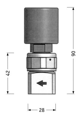
Adaption für Näherungsinitiatoren, Rückmeldung **auf / zu**, kann auf vorhandene VSM-Membranventile mit pneumatischem Antrieb nachgerüstet werden.
